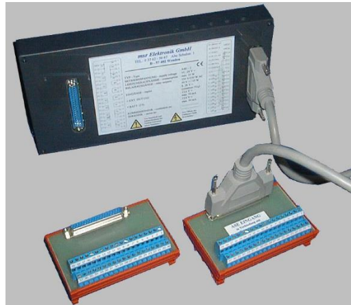
Rückseitige Ansicht mit Verbindungskabel und Anschaltmodul
