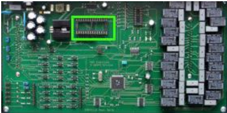
Leerer Sockel zum Einsetzen des E-Proms mit dem Anwenderprogramm
